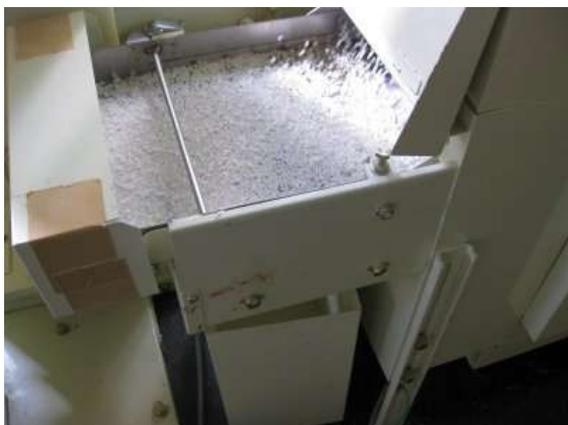
精米された米は振動網の上を移動し、次へ運ばれる。ここでは移動の過程で、一定の大きさより小さい米は網の大きさの関係で下へと落ちていく。そうすることで一定以上の大きさの米粒だけを確保することができ、商品として販売することができるのである。
