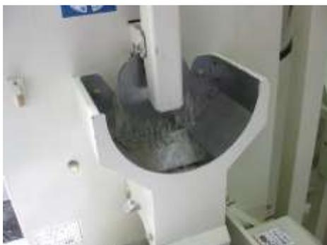
混入物を取り除かれた玄米は精米機にかけられる。精米というのは米の外側についている茶色い部分、いわゆる米ぬかを精米機にかけてそぎ落とし、家庭で見るとような白米の状態に持っていくことである。機械の中には金属製のやすりのような部品（写真4）がついており、これによって玄米が白米へと精米されていくのである。
