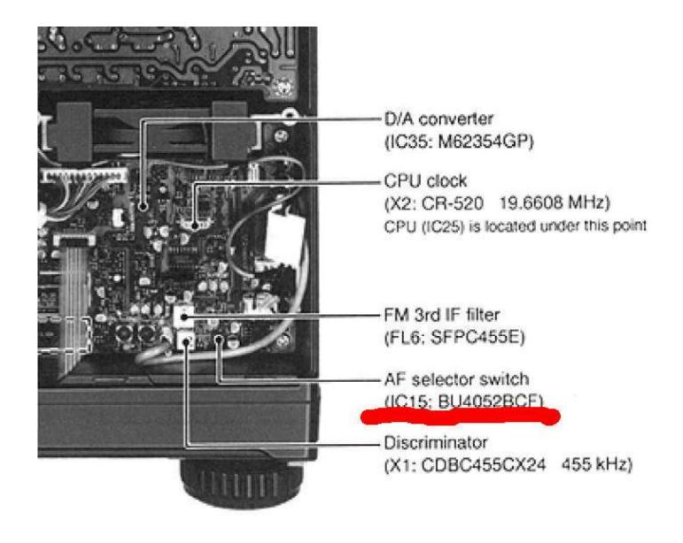
上図の IC15 が音声信号を MODE ごとに切り替えたり、スケルチで ON/OFF している、
