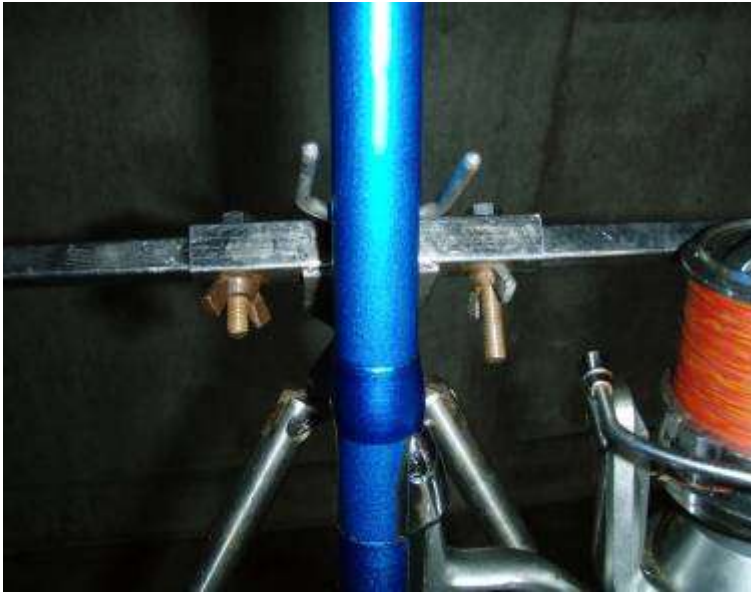
ワイヤーからボルトで固定された竿受け部
