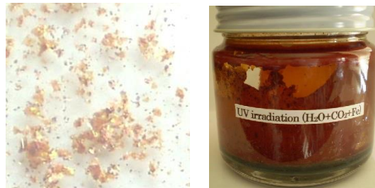
(a) 乾燥した浮遊物質 (b) 壁に生成された膜 図.4 (a) は炭酸水とスチールウールから作られ、乾燥した浮遊物の写真である。図 4 (b) は #300 の鉄粉末 5g を炭酸水の 90 cc と混合したガラス容器の壁に付着して形成された膜の写真である。
