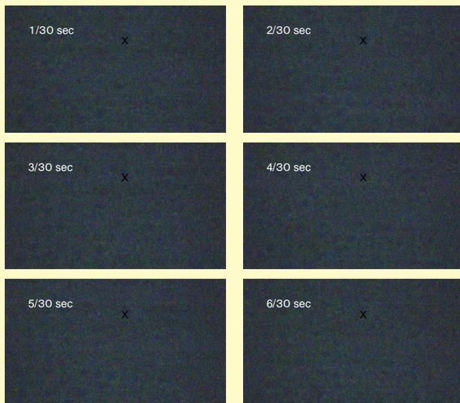
図8. 4000倍拡大のデジカメの動画をコマ送りで見る水中の微粒子の熱運動ここで、[X]印は動きの少ない粒子を示す。
