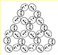
図5. 交叉している3方向の電気軸
