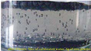
図.1 炭酸水中での鉄の酸化による気泡の生成
