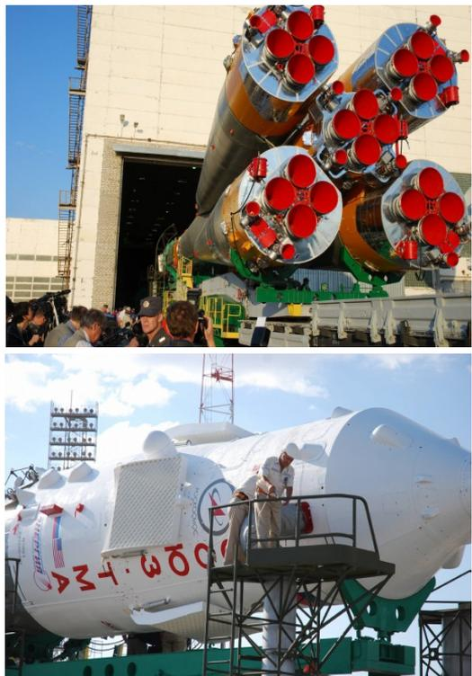
右はソユーズロケットのエンジン部分(上の写真)と有人カプセル部分(下の写真)です。有人カプセル部分には4枚のペダルが取り付けられています。また右の方には写っていませんが打ち上げ時の事故に備えた脱出口ケットが取り付けられています。
