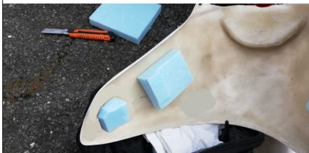
付属のスチロールにて、タンクの面に合う様少しずつ貼ったり削ったりして何度も調整します。
