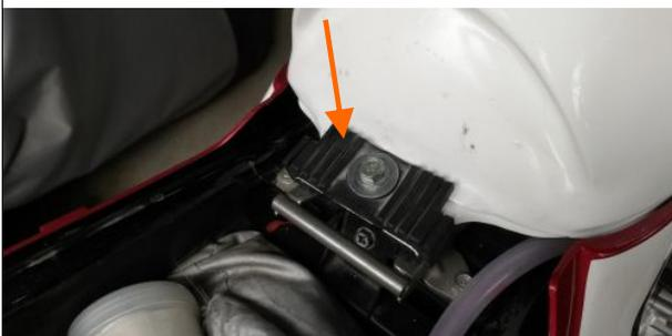
少し強引ですが、ラバーマウントで抑え込む様な感じで固定します。
