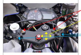
・両方のハンドルを挿しボルトで仮止めします。
