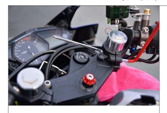
フォークトップにクランプされてるボルトを緩めます。 トップブリッジに固定されてるボルトを外します。 ハンドルを持ち上げて抜きます。
