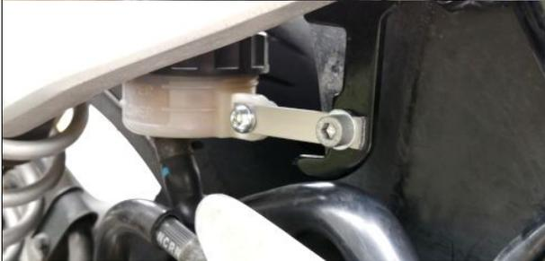
純正ボルトを再利用し、元の穴へ固定する。
