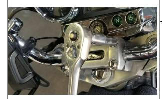
片側 2 本ずつ固定してあるボルト計 4 本を外しま す。
