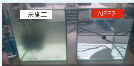
▲ 水槽施工試験
