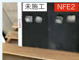
▲ 氷をつけたガラスパネル面の融解実験 (3 分後)
