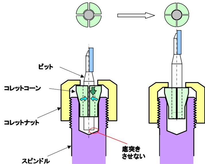
コレットナットを締めこむことにより、コレットコーンの割り溝が狭くなり、ビットの側面を均等に圧することで固定する構造。したがって、ビットをスピンドルの挿入溝に奥まで入れて底突きさせると軸の中心が出なくなり、刃に負担をかける。右側のように、コレットコーン内面部分の大半にビット側面が当たっていれば、奥まで入れなくてもOK。
