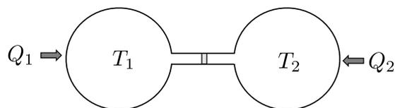
それでは流体力学的には自明に近い圧力平衡「 $p_1 = p_2$ 」は、どのようにして決まるのだろうか？ — 管の中央に、軽くて滑らかに動くことができる透熱的な仕切りを入れて固定する。仕切りの熱伝導度が低ければ、管の部分を含めて左右各域で温度が一樣かつ一定に保たれる。その後、固定をはずして仕切りが不可逆的に動くときに気体とする仕事をそれぞれ  $w_1, w_2$  とすれば、各部分に対して第二法則を適用できて
