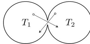
これは流出とは区別して分子噴出という。穴を通り抜ける間に他の分子と衝突しないことが条件であり、管の口径の目安は平均自由行路 (m.f.p.) より小さいことである。気体の m.f.p. は、熱運動する分子が他の分子と衝突するまでに自由に運動する距離の平均である。分子の衝突断面積  $\sigma$  (球なら直径を  $d$  として  $\pi d^2$ ) と密度  $n$  で決まり ( $\lambda = 1/\sqrt{2}n\sigma$ )、標準状態の通常気体では  $10^{-7}$  m 程度である。常識的な金属パイプなら、よほど希薄な気体でない限りまず心配することはない。
