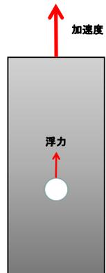
回転する水では、慣性力(遠心力)は外向きですから、その反対向きに中心方向の浮力を生じます。したがって浮かんでいるゴミは、遠心力とは逆に真ん中を集まろうとします。
