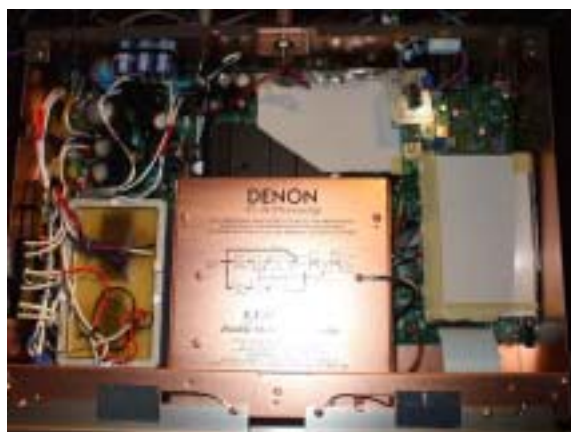
ルビジウム発信器と電源部
