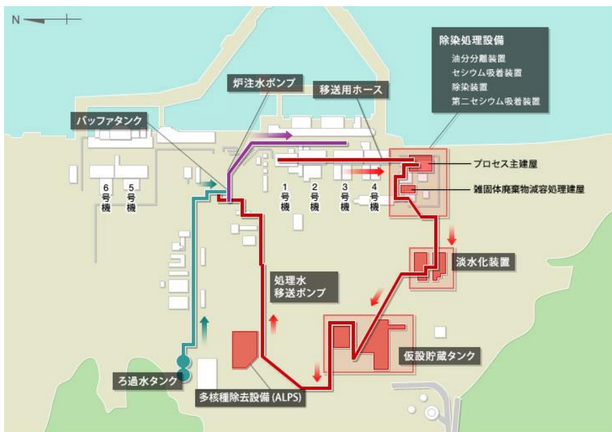
福島第一原発の循環冷却システム
