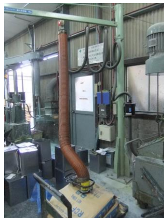
この投入作業における腰痛予防対策として導入した設備が、袋を吸引して持ち上げる「バキュームリフト」（右写真）です。このバキュームリフトを使用することで、二〇kgの袋を片手で楽に持ち上げることが出来るようになったので、投入口まで袋を担ぎ上げる作業がなくなり、労働者の腰への負担が大きく軽減しました。この設備を導入してから、粉末の投入作業で腰痛が発生したという報告は今のところありません。
