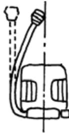
パワーブスター(01 年カタログ落ち)は炎の熱エネルギーをカートリッジまで移動させ、LPG 気化に伴う気化熱を相殺するもの。初期モデルはヒートパイプが細く、カートリッジ内のガスを暖めるのに十分な熱量を伝えることができなかったが、最終モデルは非常に強力になっている。EPI の同様なもの(パワーチャージャー)はコンパクトにならず、500 タイプのカートリッジにも対応せず、スノーピークからは発売されていない。冬用として画竜点青を欠く。04 年、EPI から集熱部が可動式、軽量(68g)なニュータイプが発売された。しかし、相変わらず
