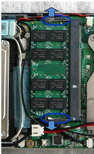
なお、メモリ交換の際、無線LANカードから出ているアンテナ線が若干邪魔になりましたので、新しいメモリをスロットへ挿入して下方向へ押し込む際は、アンテナ線を挟まないように注意が必要です。
