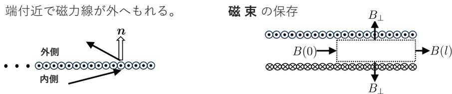
垂直2等分面上での磁束密度 もれ出た磁力線は外側の空間を通過して左右でつながる。(2)からも想像されるように半径  $a$  の円電流は  $\pi a^2 I$  の磁気モーメント (EB 対応 → 雑書庫 [214]) に等価である。長さ  $2l$ 、巻き数密度  $n$  の細長いソレノイドの磁気モーメントは  $2nl \times \pi a^2 I = 2l \times \pi a^2 nI$  であり、端から少し離れた位置 から見れば、両端に  $\pm q'$  ( $q' = \pi a^2 nI$ ) の磁極が置かれたと見なすことができる。したがって、ソレノイドの外側の垂直2等分面上での磁束密度は、半径  $r$  の位置で軸に平行に
