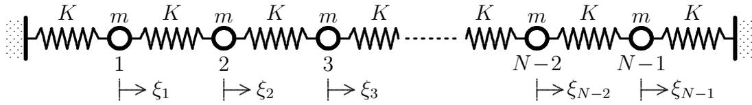
$N - 1$  個の質量  $m$  の原子が，ばね定数  $K$  のばねでつながれ，両端も同じばね定数のばねで固定されているとする。 $\{\xi_i\}$  を鎖に沿った方向の変位として運動方程式は
